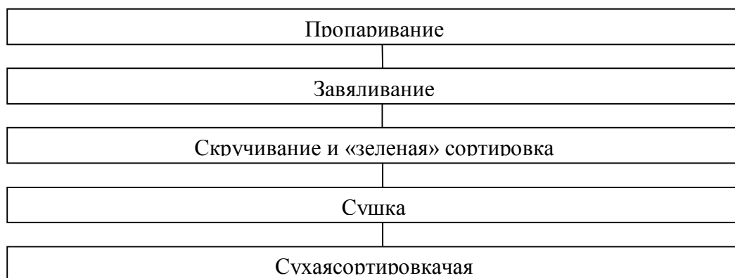
Рисунок 2 – Технологии производства зеленого чая
