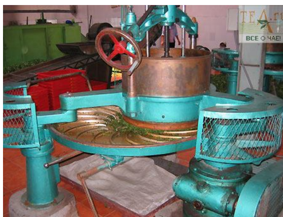
Рисунок 3 – Процесс скручивания чайного листа в жаровом шкафу
